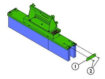
2. Sostituire tutte le setole necessarie (3) e rimontare la spazzola meccanica in ordine inverso. Sovrapporre gli elementi di lunghezza disuguale per evitare di allineare le giunture come mostrato nella figura sottostante.
